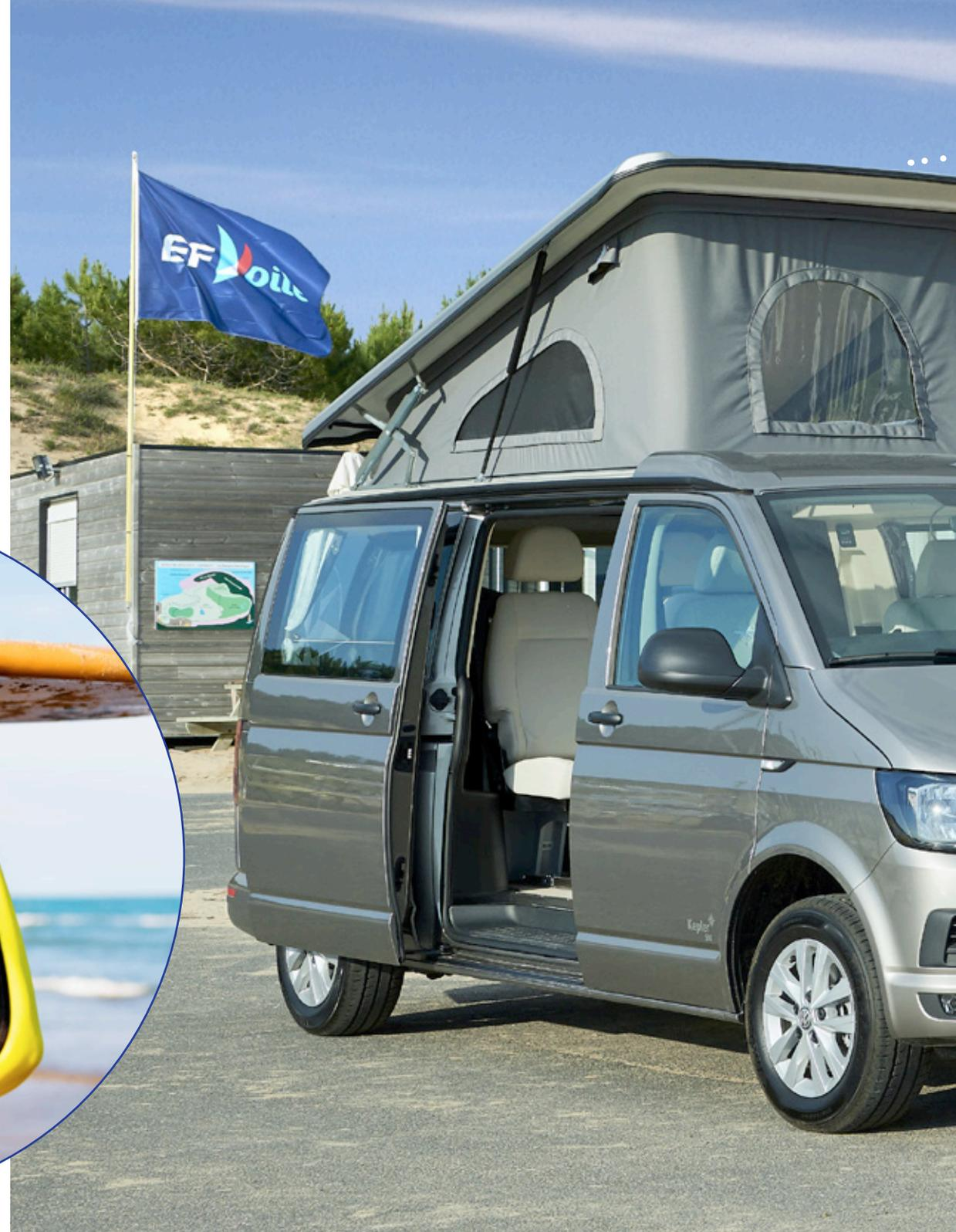
Neben dem Doppelbett im Aufstelldach verfügt der Kepler Six aufgrund seines Fahrzeugkonzeptes noch über ein weiteres Bett im Bereich des flexiblen Wohnraums. So lassen sich die Sitze mit wenigen Handgriffen zu einem großzügigem Doppelbett von ca. 2 m Länge umbauen.
